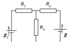
31. Цепь содержит две батареи с ЭДС  $3\text{В}$  и  $17\text{В}$  с внутренними сопротивлениями  $2\text{Ом}$  и  $3\text{Ом}$ , три резистора  $12\text{Ом}$ ,  $11\text{Ом}$  и  $13\text{Ом}$  и идеальный амперметр. Найти показания амперметра. Положительный полюс одной батареи присоединен к положительному полюсу другой батареи.
