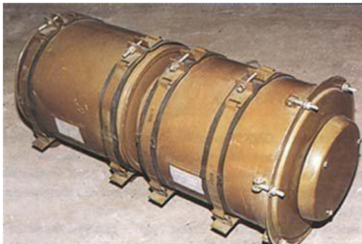
Рисунок 1.8. Внешний вид ФВУА- 100А
