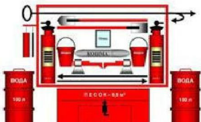
Рисунок 3.2. Оборудование пожарного щита.
