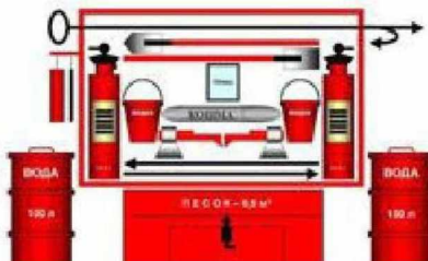
Рисунок 3.2. Оборудование пожарного щита.
