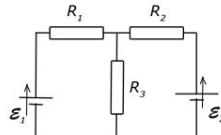
31. Цепь содержит две батареи с ЭДС  $3V$  и  $17V$  с внутренними сопротивлениями  $2\Omega$  и  $3\Omega$ , три резистора  $12\Omega$ ,  $11\Omega$  и  $13\Omega$  и идеальный амперметр. Найти показания амперметра. Положительный полюс одной батареи присоединен к положительному полюсу другой батареи.
