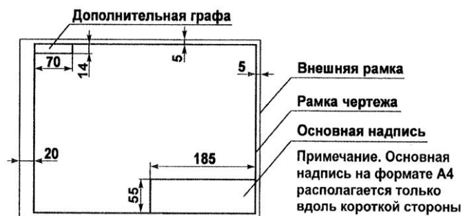
Рисунок 1 - Оформление поля чертежа
