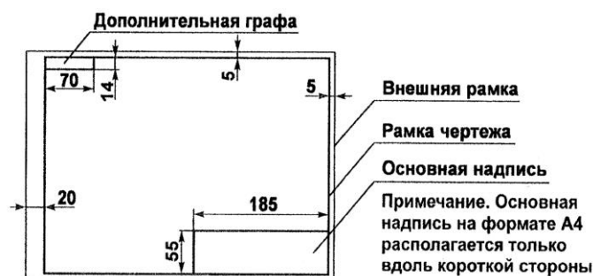
Рисунок 1 - Оформление поля чертежа
