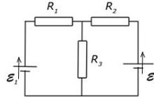
31. Цепь содержит две батареи с ЭДС 3В и 17В с внутренними сопротивлениями 2Ом и 3Ом, три резистора 12Ом, 11Ом и 13Ом и идеальный амперметр. Найдите показания амперметра. Положительный полюс одной батареи присоединен к положительному полюсу другой батареи.
