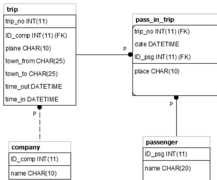
Рис. 6. Схема базы данных «Аэрофлот»
