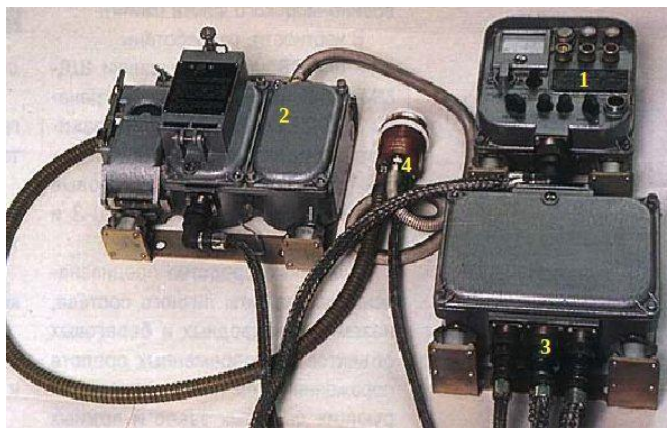
Рисунок 2.6. Прибор радиационной и химической разведки (ПРХР): 1-пульт измерительный; 2-датчик; 3-блок питания; 4-устройство для забора воздуха («циклон») с трубкой обогрева и трубкой выходной.
