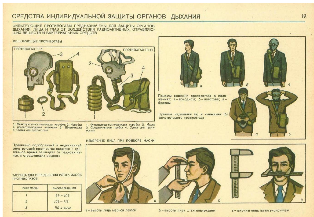
Рисунок 1.4. Средства индивидуальной защиты органов дыхания.
