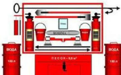
Рисунок 3.2. Оборудование пожарного щита.
