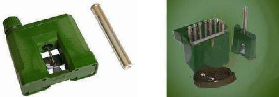
Рисунок 2.9. Комплект войсковых измерителей дозы ИД-1
