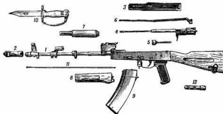
Рисунок 20.1. Основные части и механизмы автомата
