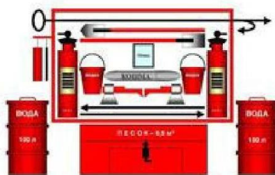
Рисунок 3.2. Оборудование пожарного щита.
