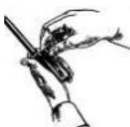
8. Затворную раму с затвором разделить на две части взять затворную раму в левую руку затвором кверху; правой рукой отвести затвор назад, повернуть его так, чтобы ведущий выступ затвора вышел из фигурного выреза затворной рамы, и вывести затвор вперед.
