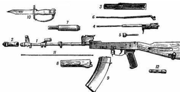
Рисунок 20.1. Основные части и механизмы автомата
