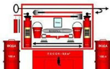
Рисунок 3.2. Оборудование пожарного щита.
