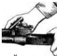
9. Отделить газовую трубку со ствольной накладкой. Удерживая автомат левой рукой, правой рукой надеть пенал принадлежности прямоугольным отверстием на выступ замыкателя газовой трубки. Повернуть замыкатель от себя до вертикального положения и снять газовую трубку с патрубком газовой камеры.
