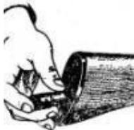
3. Вынимаем пенал – находится в прикладе
