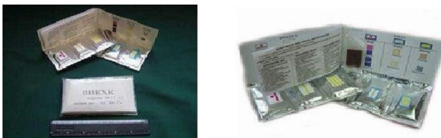
Рисунок 2.12. Войсковой индивидуальный комплект химического контроля (ВИКХК)
