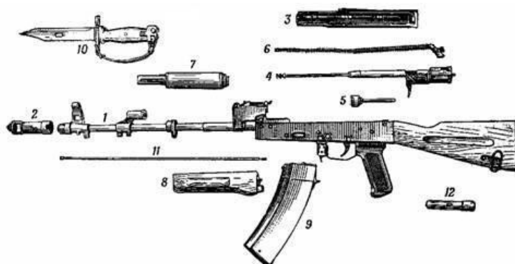
Рисунок 20.1. Основные части и механизмы автомата
