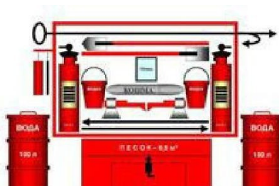
Рисунок 3.2. Оборудование пожарного щита.
