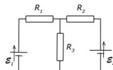
31. Цепь содержит две батареи с ЭДС 3В и 17В с внутренними сопротивлениями 2Ом и 3Ом, три резистора 12Ом, 11Ом и 13Ом и идеальный амперметр. Найти показания амперметра. Положительный полюс одной батареи присоединен к положительному полюсу другой батареи.
