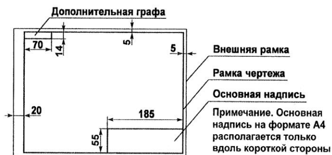
Рисунок 1 - Оформление поля чертежа
